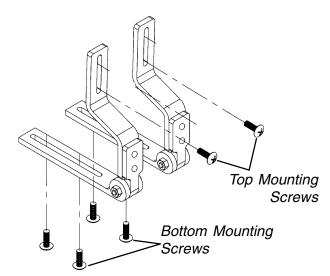
FIGURE 3 - ATTACHING / ADJUSTING THE ADJUSTABLE ANGLE GROWTH BRACKET
